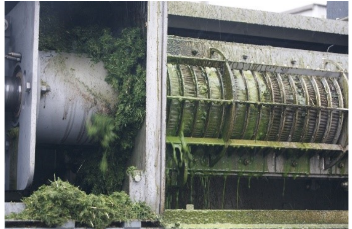
Figur 2: Skruepresning af frisk kløvergræs til grøn saft og pressekage. Foto: Erik Fog, SEGES
