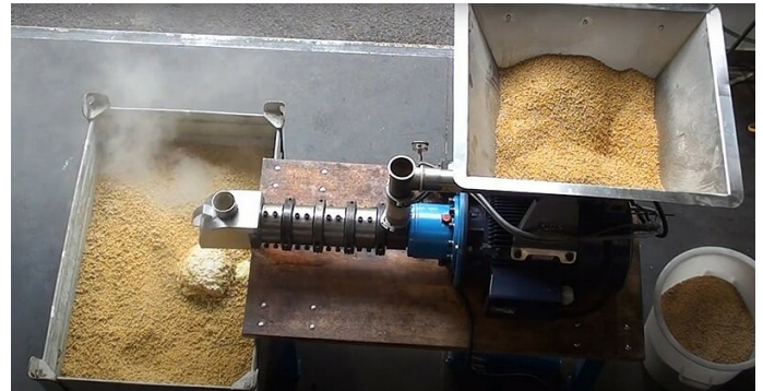
Foto 2: Ekstruderingsteknologien anvender en kombination af tryk og friktion til at skabe behandlingstemperatur. Foto: www.farmet.cz/en
