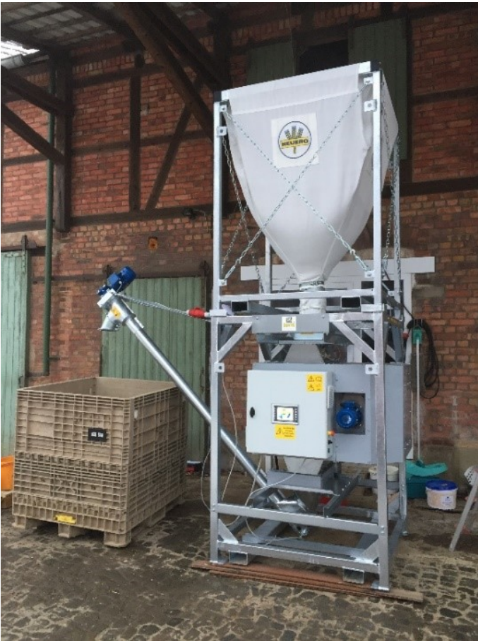
Foto 1: Ristningsteknologi behandler sojabønner med damp eller varm luft. Foto: EST GmbH
