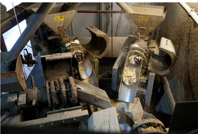
Foto 4: Ölpressen sind in der Sojabohnenverarbeitung üblich. In diesem Fall sind vier Pressen kombiniert. Bild: Donau Soja
