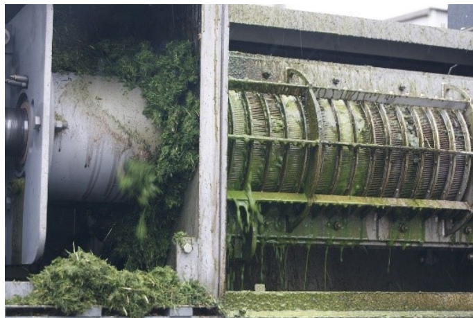
Figura 2: Prensado en tornillo de la hierba fresca de trébol para obtener zumo verde y torta de prensado. Foto: Erik Fog, SEGES
