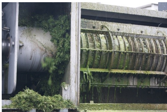
Figure 2 : Pressage à vis de l'herbe de trèfle fraîche en jus vert et en gâteau de presse. Photo : Erik Fog, SEGES
