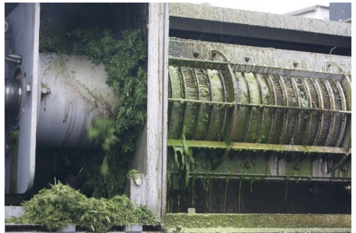
2. ábra: A friss lóherefű csavaros préselése zöld lére és présogácsára. Fénykép: Erik Fog, SEGES
