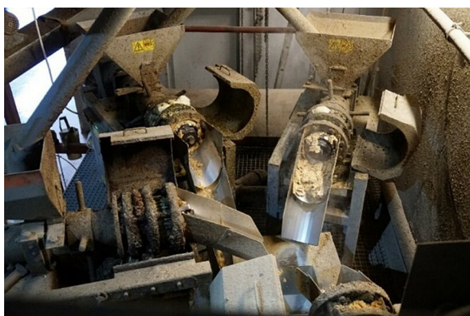
Foto 4: Le presse per olio sono comuni nella lavorazione dei semi di soia. In questo caso, quattro presse sono combinate. Foto: Donau Soja
