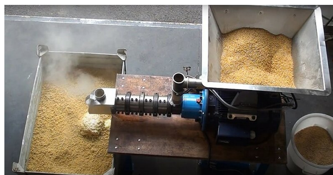
Foto 2: La tecnologia di estrusione utilizza una combinazione di pressione e attrito per generare la temperatura di lavorazione. Foto: www.farmet.cz/en
