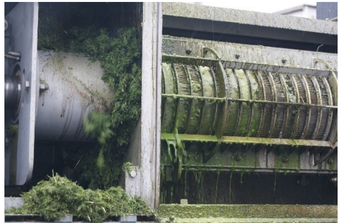
Figur 2: Skruvpressning av färskt klövergräs till grön saft och presskaka. Foto: Erik Fog, SEGES
